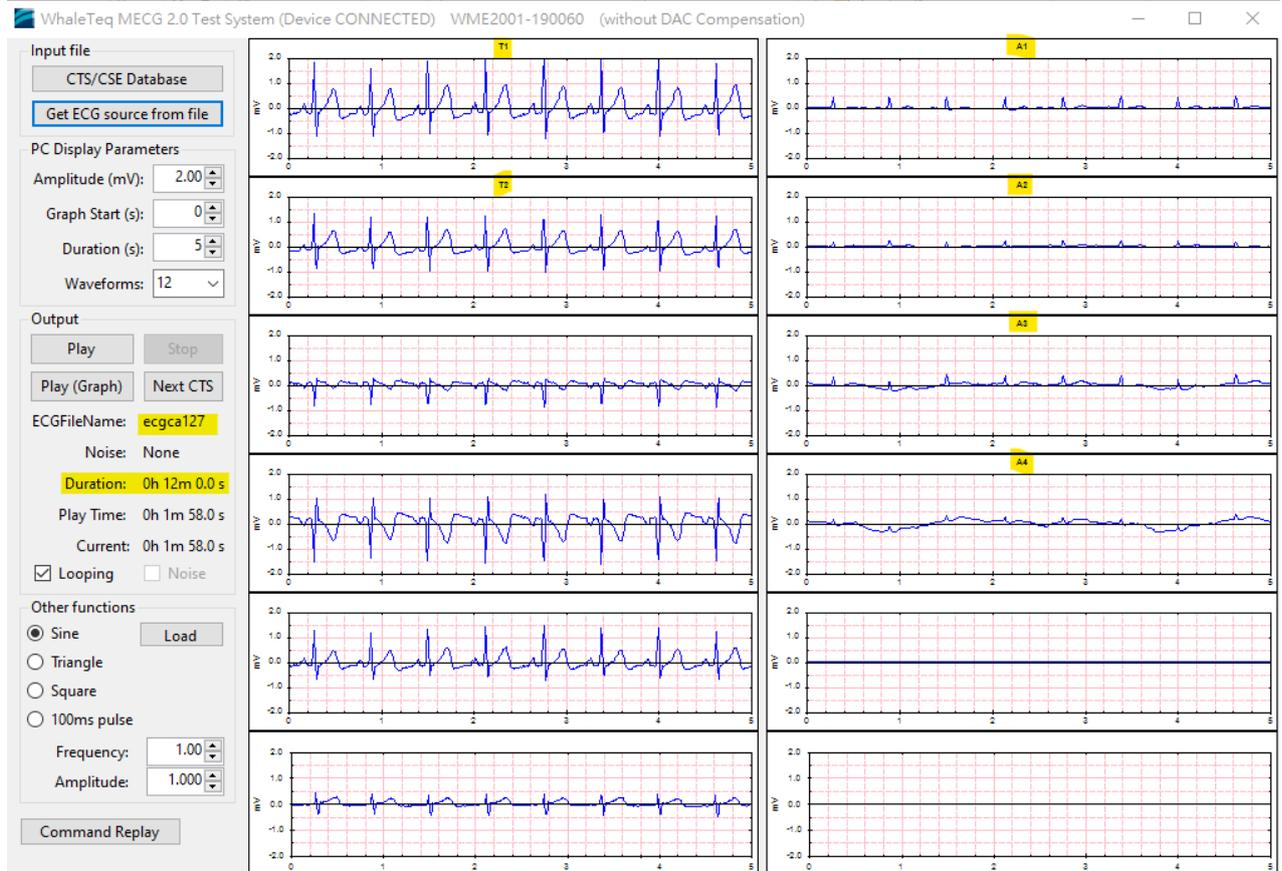
图 6, MEGC 软件主画面，显示 T1/T2/A1~A4 输出波形
