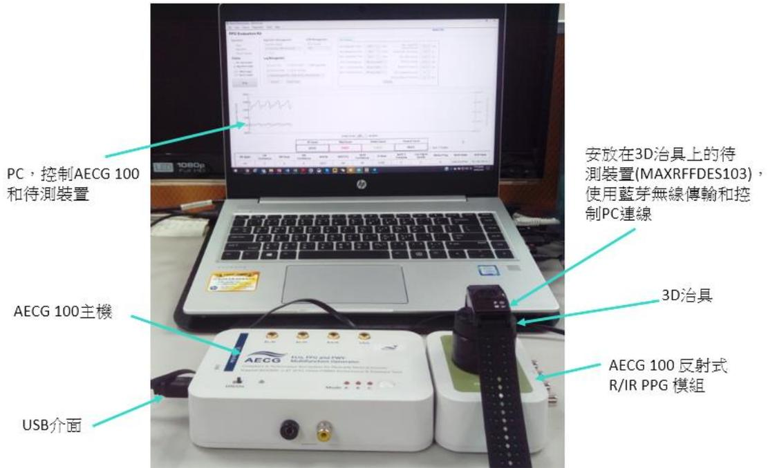
图 3、测试反射式穿戴装置 SpO2 的系统图
