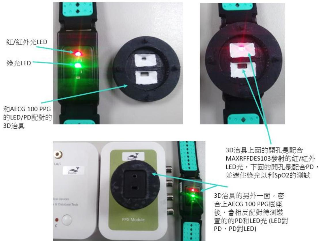
图 2、一个配对的 3D 治具密合连接 AECG100 PPG 和 DUT，用来测试 SpO2
