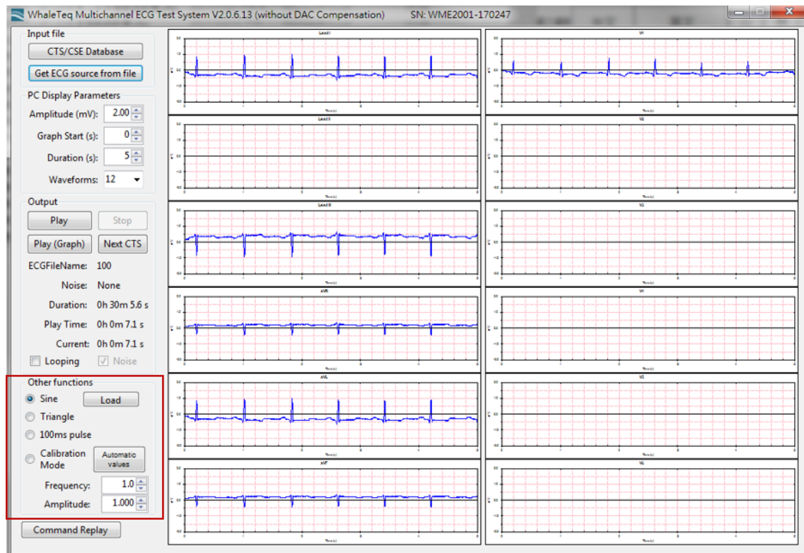
圖 7、MECG 2.0 將 MIT 100 數據輸出並改變對應導聯的例子，右半部顯示了待測心電圖機上應顯示的各導聯波形
