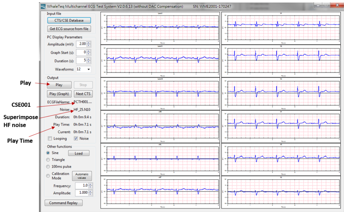
圖 5、MECG 2.0 將 CSE001 數據輸出並疊加高頻噪聲的例子，右半部顯示了待測心電圖機上各導聯應顯示的波形的畫面
