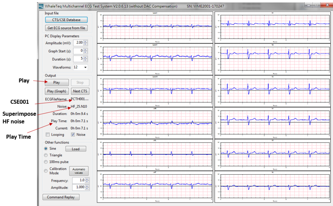
图 5、MECCG 2.0 将 CSE001 数据输出并叠加高频噪声的例子，右半部显示了待测心电图机上各导联应显示的波形的画面
