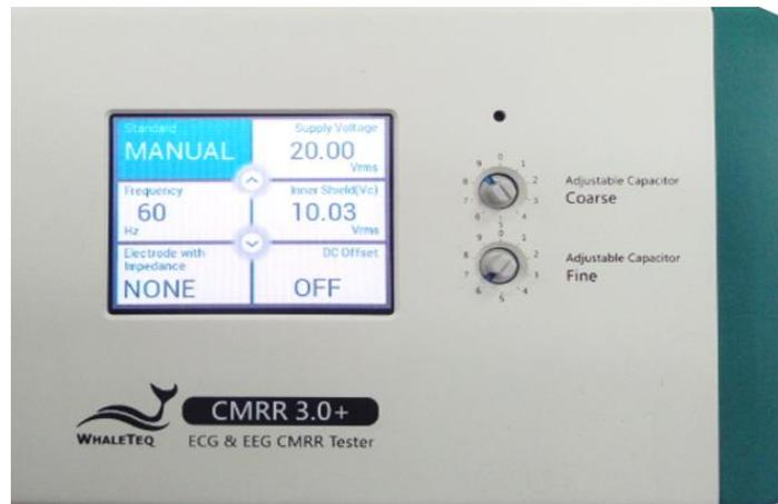
圖 4. 調整  $V_c$  電壓至  $V_s$  電壓的一半
