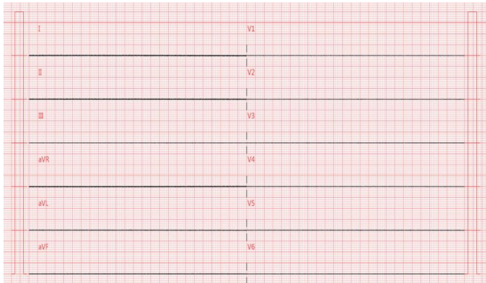
图 13：不平衡测试 (开启陷波器)
