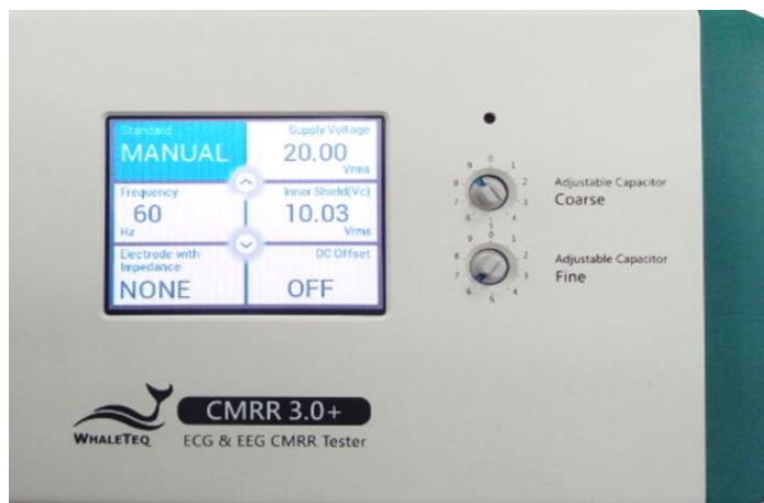
图 4. 调整 V_c 电压至 V_s 电压的一半
