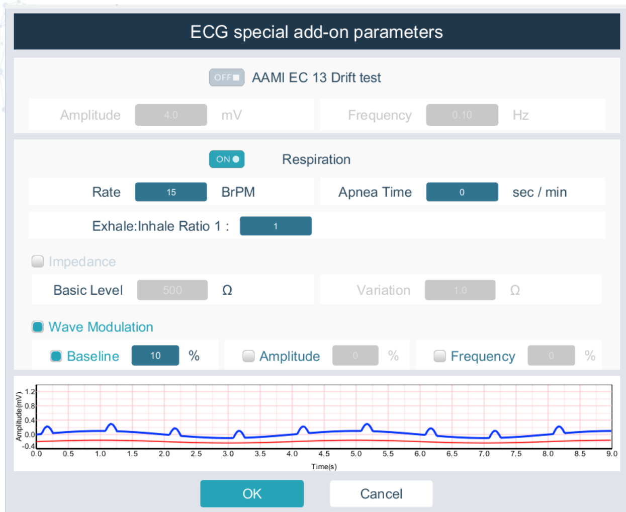
Abbildung 5. Das WhaleTeq SECG 5.0 AIO stellt AM-, FM- und BM-Atemmodulationssignale für ECG-Geräte bereit.
