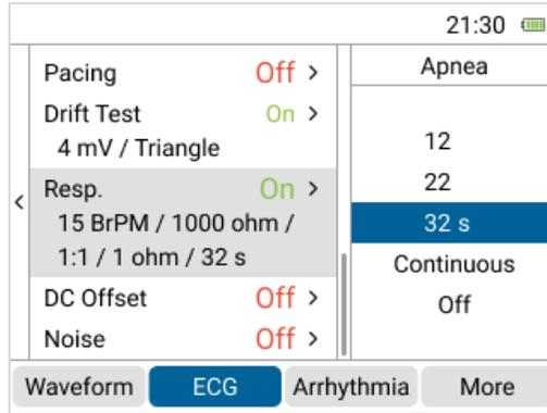
图 31: 「呼吸 (Respiration)」参数的「呼吸中止 (Apnea)」选项
