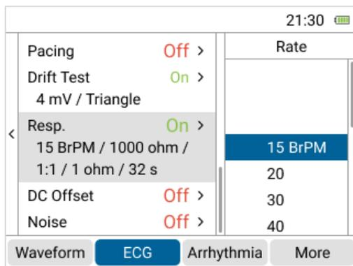
图 28: 「呼吸 (Respiration)」参数的「呼吸率 (Rate)」选项
