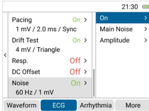
图 34: 「噪声 (Noise)」 参数的「On/Off」选项
