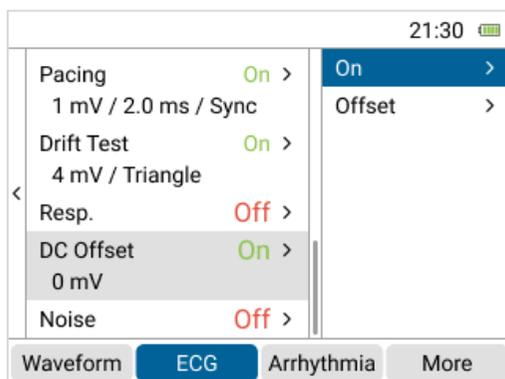
图 32: 「直流偏移 (DC offset)」 参数的「On/Off」选项
