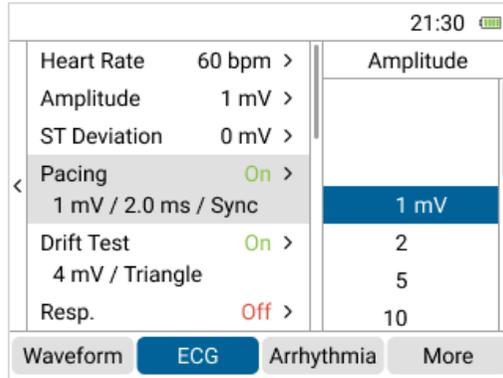
图 24: 「起搏 (Pacing)」参数的「振幅 (Amplitude)」选项
