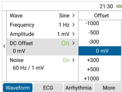
图 8: 「直流偏移 (DC offset)」 参数的选项
