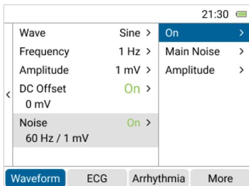
图 9: 「噪声 (Noise)」 参数的「On/Off」选项
