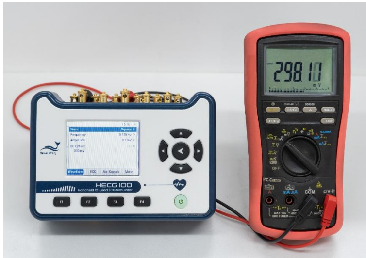
图 63: 验证直流电压架设示意图
