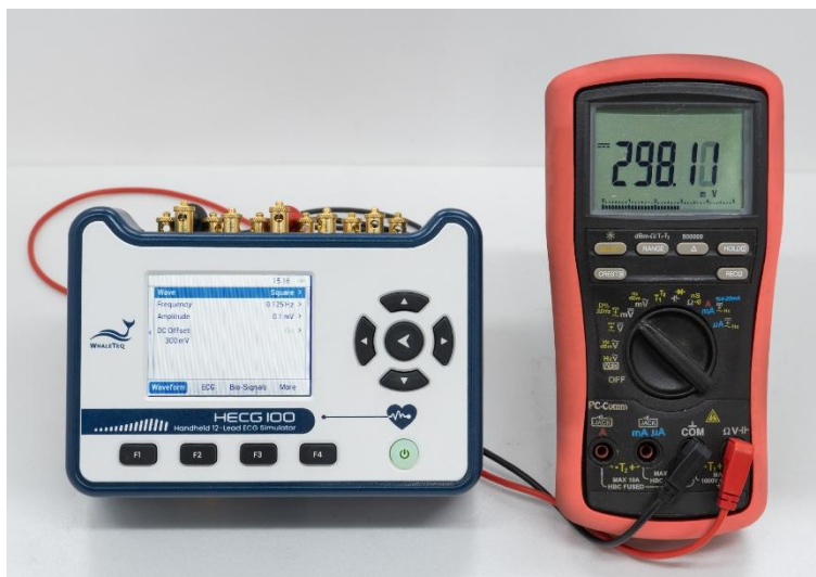
圖 63：驗證直流電壓架設示意圖
