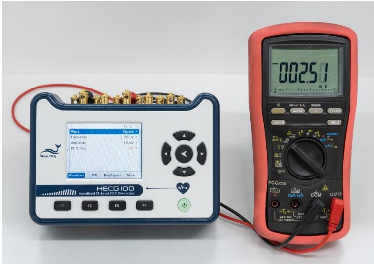
圖 60：簡易自我校準架設示意圖
