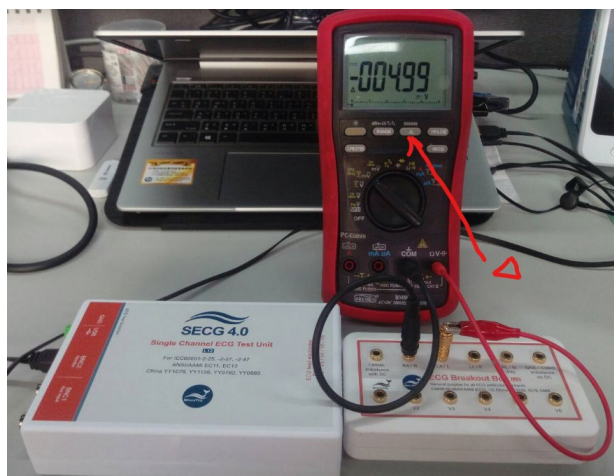
圖 33：自我校準架設示意圖
