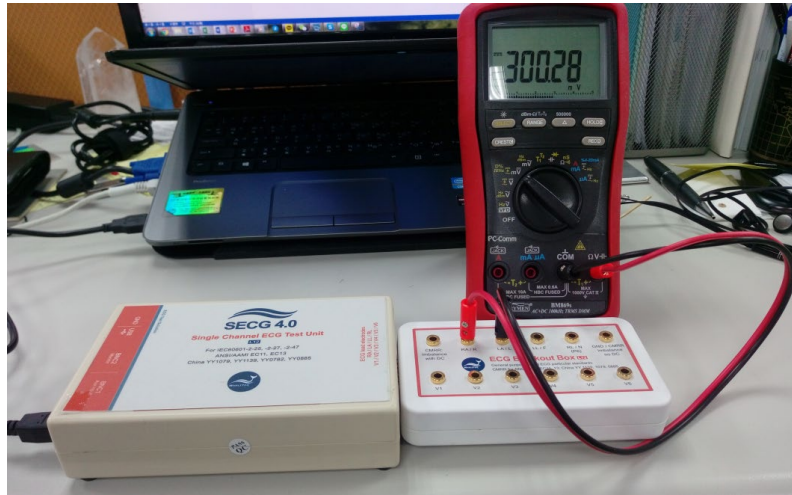
圖 36：自我校準架設示意圖
