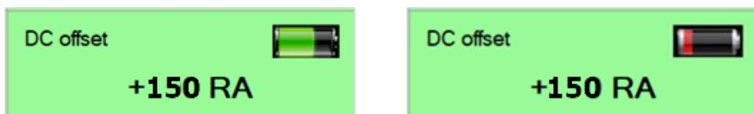
圖 21：內裝可替換電池正常電量（左）和低電量（右）圖示
