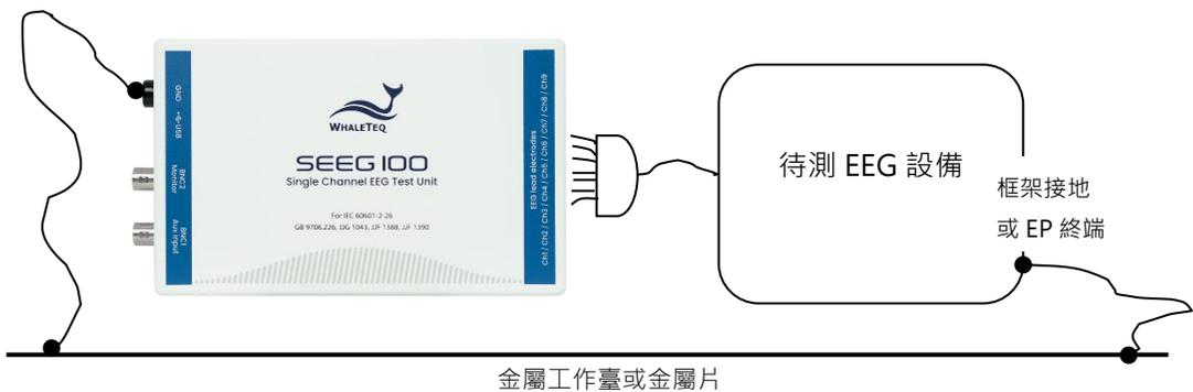
圖 6：低雜訊測試環境架設
