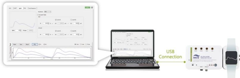
图 11: SpO<sub>2</sub>反射式模块测试模式产品接线图
