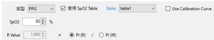
图 73: Use Calibration Curve 功能
