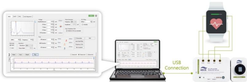
图 7：ECG 测试模式产品接线图
