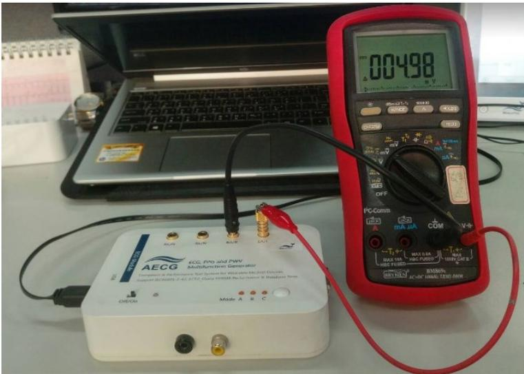
图 90: 自我校准架设示意图
