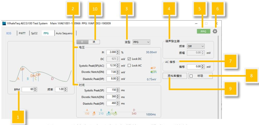
图 38: 反射式和穿透式血氧模块 PPG 模式界面按键
