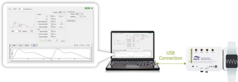
图 9：PPG Heart Rate 反射式模块测试模式产品接线图
