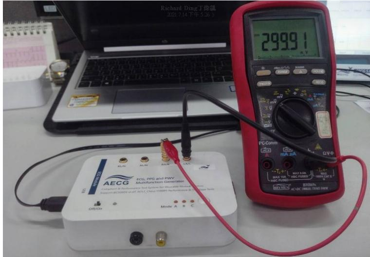
图 93: 自我校准架设示意图
