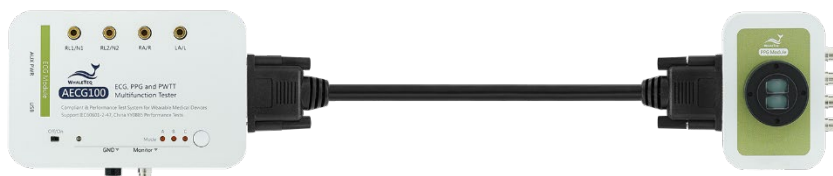
圖 5：主機透過 DB15 線材與反射式模組相接
