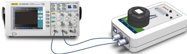
图 12: HRS200 连接示波器接线图
