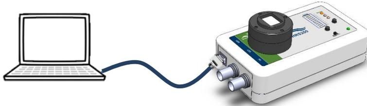
图 11: HRS200 测试接线图
