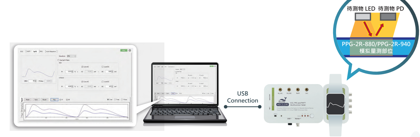
( 测试设置图以 PPG-2R-880/PPG-2R-940 和 AECG100 示意。PPG-2R-880/PPG-2R-940 搭配 AECG100 或 SECG 5.0 AIO 的详细安装和操作方式，请参考使用手册。 )
