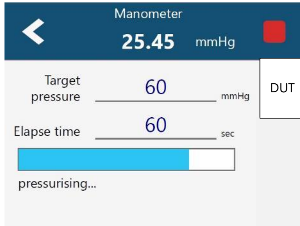
图 62：泄漏测试加压中
