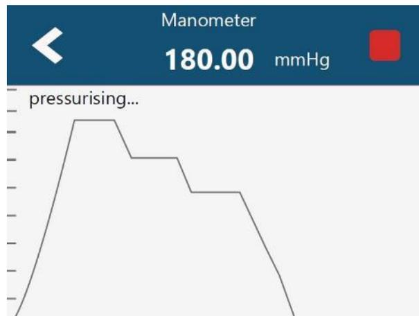
圖 58：靜態壓力測試結果
