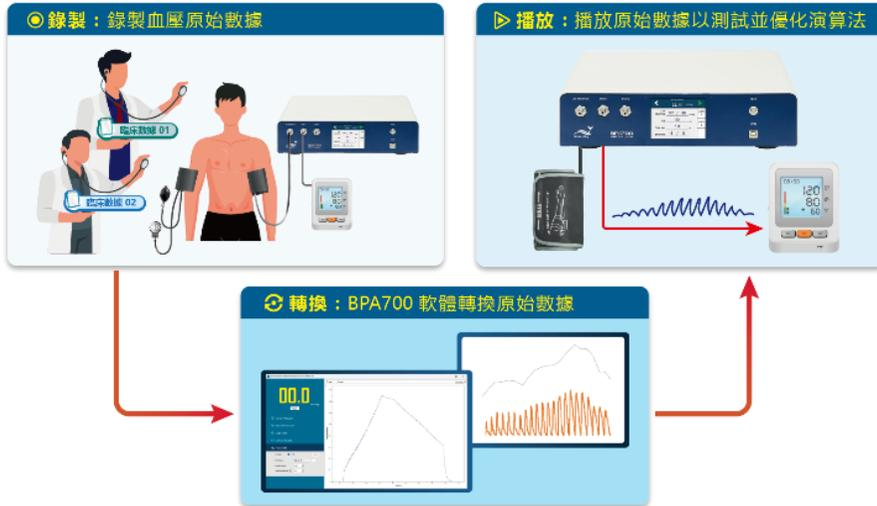
圖 45：波形播放與錄製基本設置
