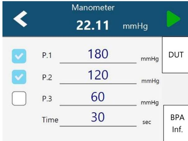
圖 57：靜態壓力設置
