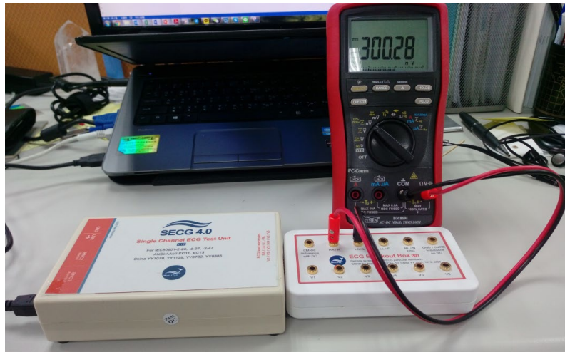
图 35: 自我校准架设示意图
