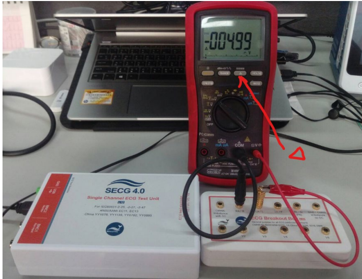
图 32: 自我校准架设示意图
