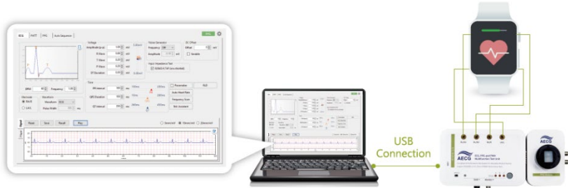
图 7：ECG 测试模式产品接线图
