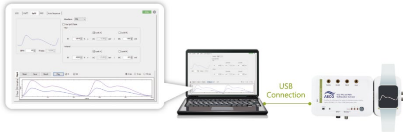
图 11: SpO 2 反射式模块测试模式产品接线图
