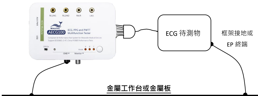
圖 8 : 降低雜訊 ECG 測試模式產品接線圖
