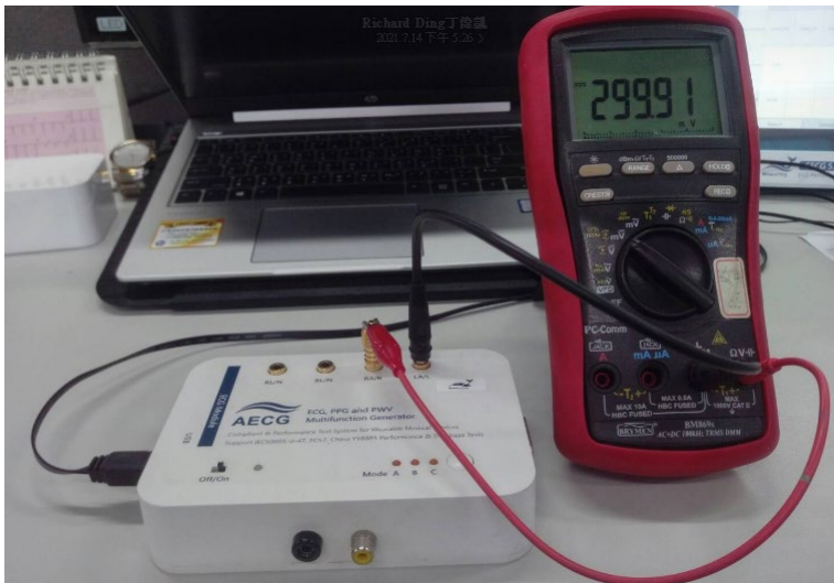
圖 93：自我校準架設示意圖
