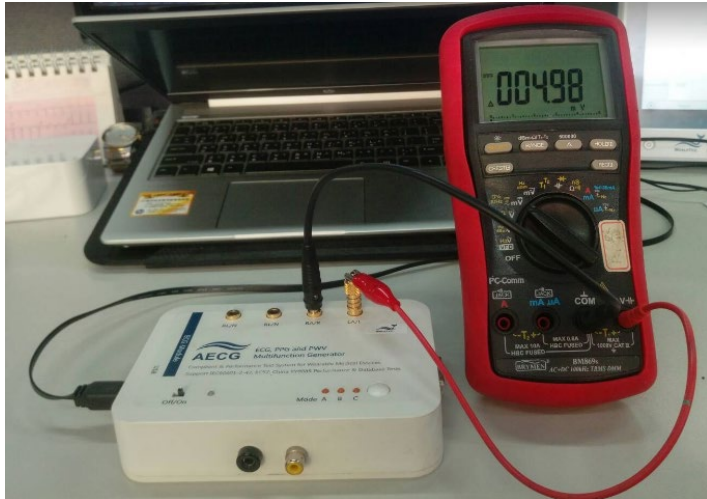
圖 90：自我校準架設示意圖
