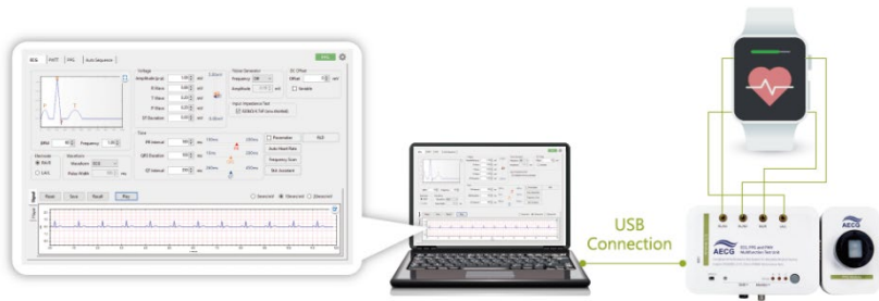
圖 7 : ECG 測試模式產品接線圖
