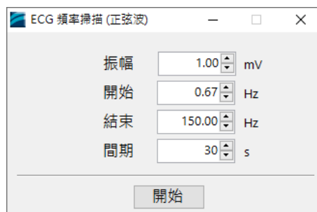
圖 31：頻率掃描測試設定
